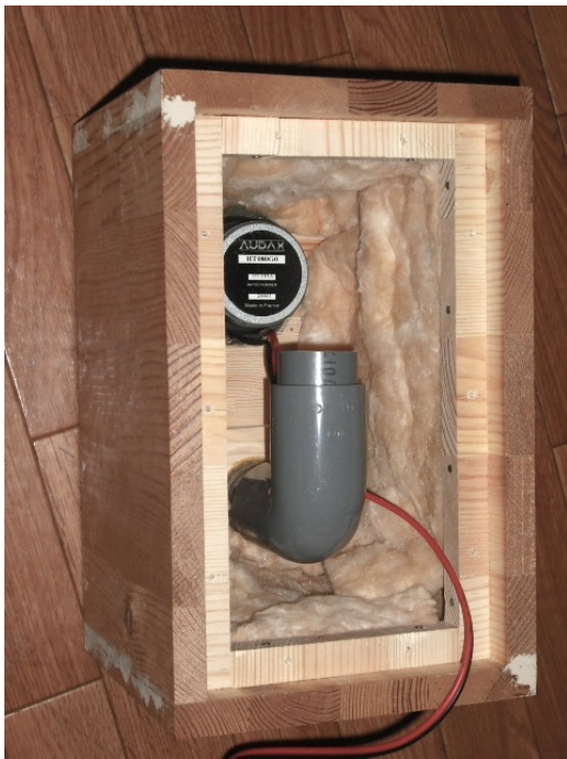
写真 1 エルボ使用例
