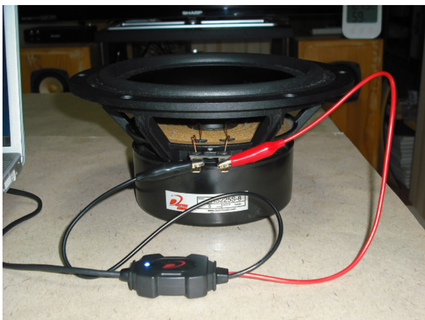
写真3 WT3 クリップで S P へ接続
